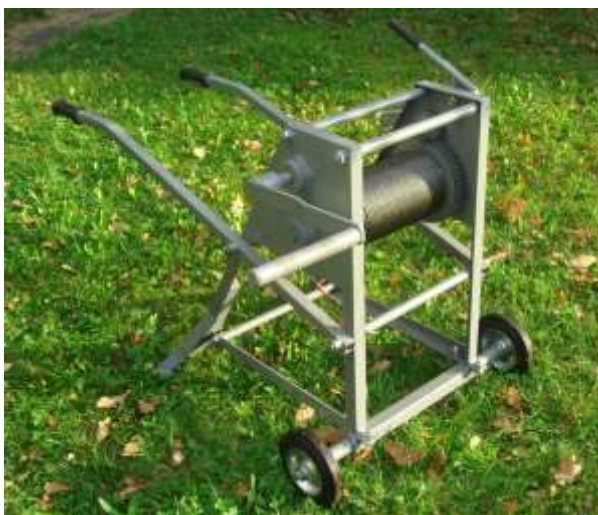
Рис.9. Ручная лебедка ДКТ-203 с усилием 5 кН
