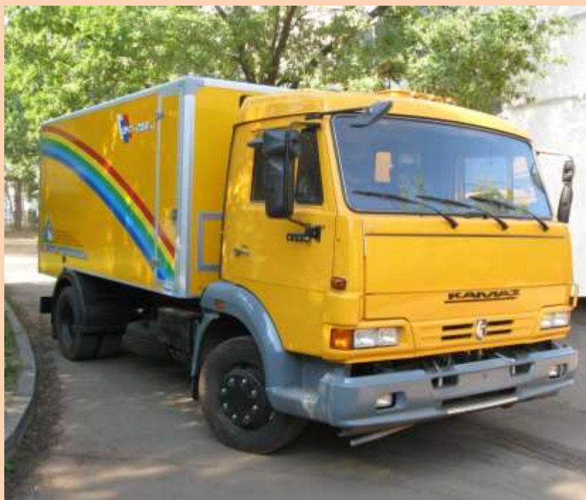
Рис. 3. Малогабаритная каналопромывочная машина ДКТ-285В
